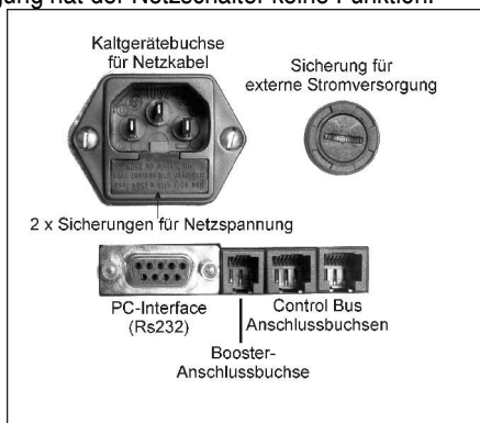
Abbildung 4: Stromanschluss, Sicherung, PC Interface, Booster und 2 x Busanschluss
